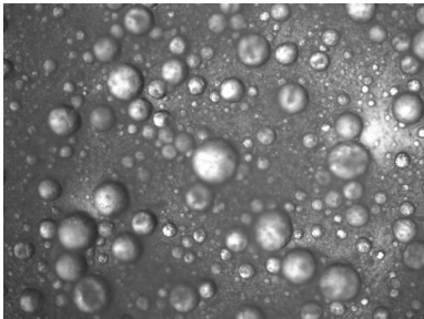
图 4 分散剂用量 30%时 POP 偏光显微镜的照片 Figure 4 Polarization microscopy of POP at 30% dispersant
